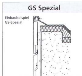
Gekantete Sonderlösungen zur Dachrandverkleidung, mehrteilig, Blenden gekantet aus Aluminium AlMg 1 NQ, Unterkonstruktionen für alle Anwendungsfälle
