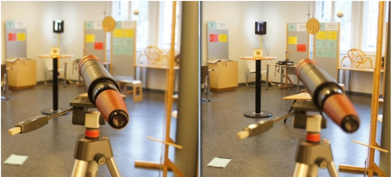
Stereobild (überkreuz): Wie Simon Marius die Jupitermonde entdeckte. Ein Aufbau aus Fernrohr und einem Scheinwerfer mit gelochter Platte, um das Licht der Monde maßstabsgetreu zu simulieren.
