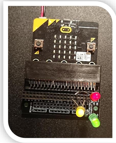
Abbildung 11: micro:bit auf Platinenstecker mit drei LEDs.
