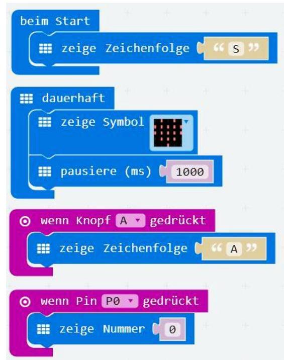
Abbildung 4: Digitale Eingaben am micro:bit mittels Pin und Taste.
