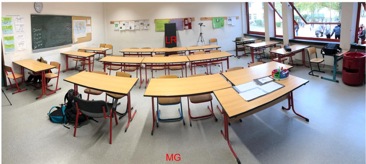
Abb. 1: Panorama-Foto des untersuchten Klassenraums (LxBxH 8 m x 8 m x 2,9 m) mit Messgerät (MG) und Luftreiniger (LR)
