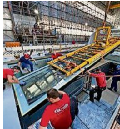
Das Schwimmbad am Heck der „Solaris“ soll einen Boden aus Glas bekommen haben.
