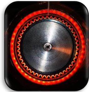
Kettenrad induktiv erwärmt
