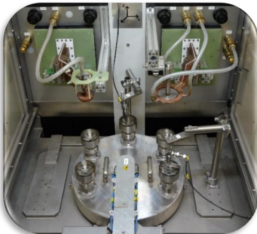
Härteanlage Thermocompact mit Drehteller
