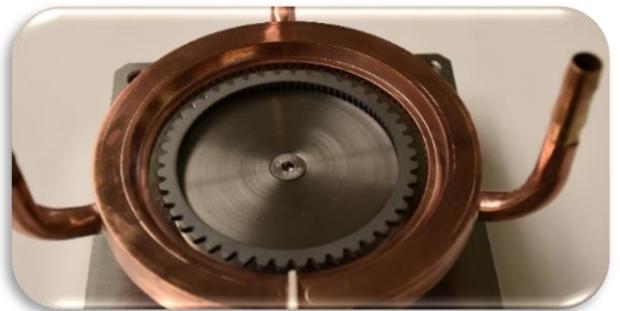
Kettenrad mit Induktor und integrierter Brause
