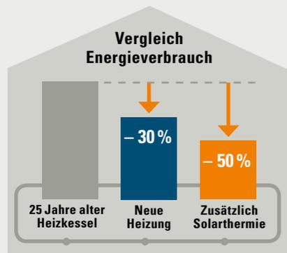
Ein 25 Jahre alter Heizkessel verbraucht im Durchschnitt rund 30 Prozent mehr Energie als ein moderner Erdgas-Brennwertkessel. In Kombination mit Solarthermie (Warmwasseraufbereitung und Heizungsunterstützung) kann der Einspareffekt sogar auf über 50 Prozent gesteigert werden.
